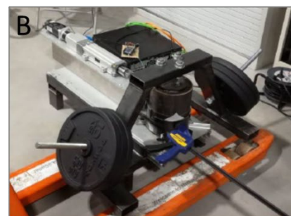
A. Schéma de la boîte de cisaillement : 1) moteur et vérin moteur, 2) capteur de force de 500 kg et 3) cylindres contenant du sol avec des racines de plantes (système sol-racines) et B. Mesure de la résistance au cisaillement d'un système sol-racines contenu dans un cylindre de 0,16 m de diamètre interne et 0,2 m de hauteur, pour une charge verticale de 60 kg.
